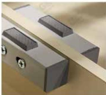
Опускание рамы происходит без шума на металлические опоры, оснащенные резиновыми демпферами.
